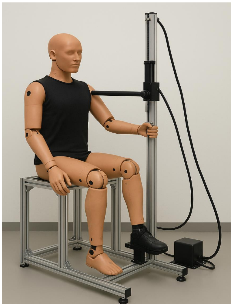
2.3-сурет – Манекенмен жүргізілген биомеханикалық сынақ стенді
